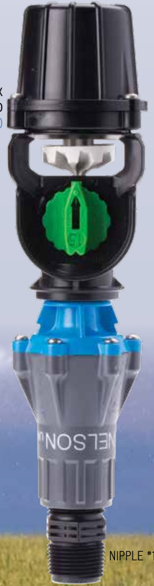
Orbitor FX / الطبق الأبيض 6-10 أرطال/بوصة مربعة (0.4-0.7 بار) المرشحة Accelerator / الطبق الأزرق 6 - 15 رطلاً/بوصة مربعة (0.4-1.0 بار)
